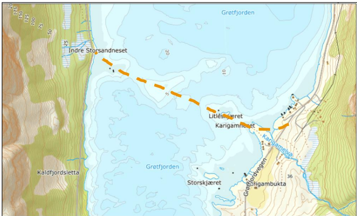
Figur 5: Fjordkryssing med foreløpig skissert trasé, topografisk kart med sjøbunnkoter, fra norgeskart.no.
